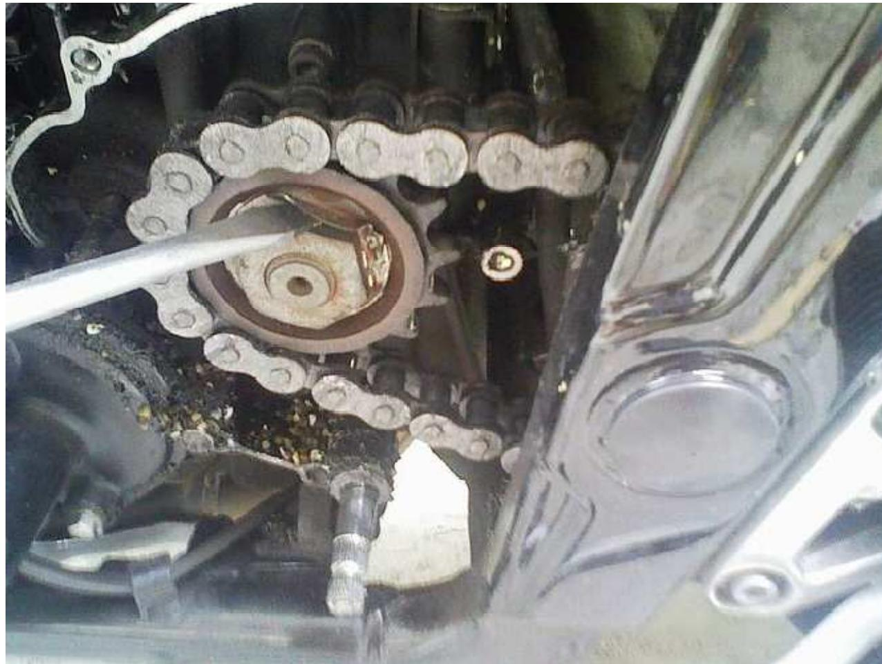
La on sort la clé de 32 pour desserrer l'écrou du pignon, pour bloquer la rotation il y a plusieurs solutions on peut mettre la barre a mine entre la jante et le bras oscillant (avec des chiffons au contact bien sur) ;moi j'ai appelé mon voisin qui est monté sur la bécane et a freiné du frein arrière. Ce n'est pas la méthode la plus propre mais l'écrou n'est pas serré fort donc le couple est limité.
