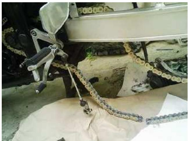
Le kit d'attache fournie par AFAM est composé de l'attache , de la plaquette extérieure, de 4 joints toriques et de 2
