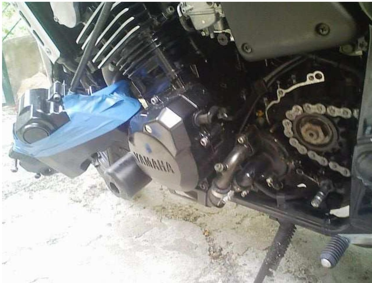
On a maintenant une magnifique vue sur le pignon et sur les blocs de graisse mélangés a des graviers , on va donc défreiner l'écrou du pignon;
