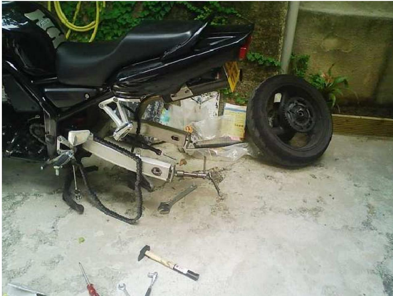
L'étrier pendouille par terre ainsi que la chaîne. La chaîne c'est le moment de l'enlever, les professionnels utilise un dérive chaîne.... 🚨 moi j'ai une disqueuse et un disque à tronçonner ,coupez direct entre deux maillons de toutes façon elle est morte!!
