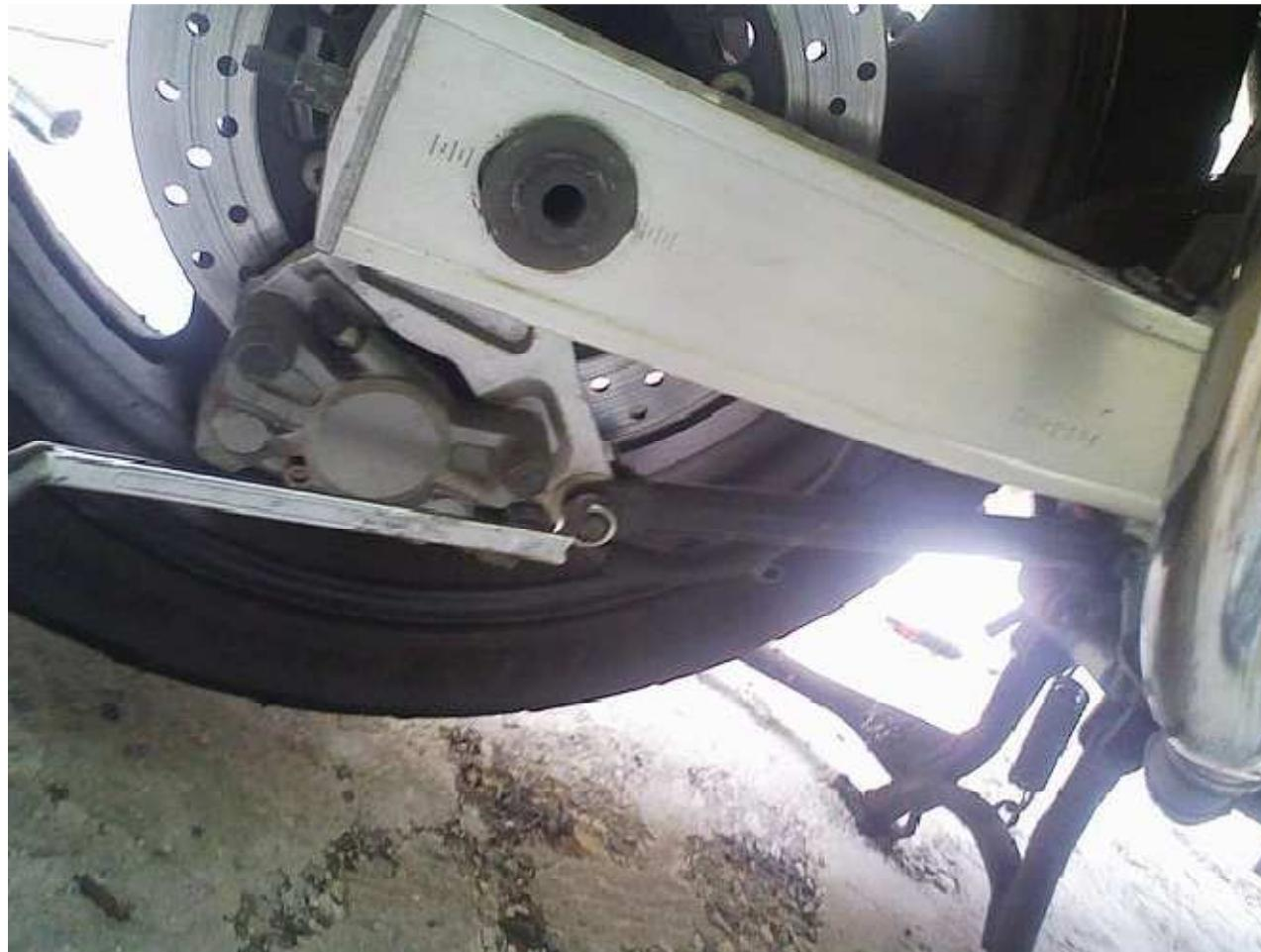
On rapproche la roue vers l'avant , on fait sauter la chaine de sa couronne et on chasse l'axe de la roue .
