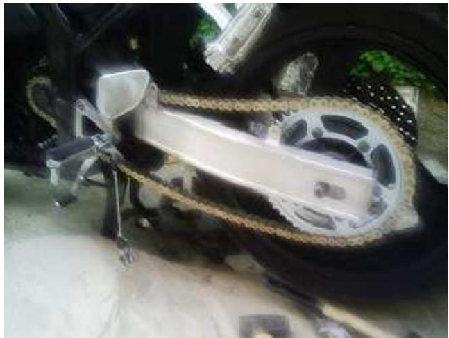
Réglage de la tension de la chaîne: on visse sans serrer l'écrou de l'axe de la roue et on serre petit à petit et simultanément les deux tendeurs; la chaîne doit avoir un débattement vertical de 2 à 3 cm et l'axe de la roue doit être au même repère à droite et à gauche du bras oscillant (repères gravés sur le bras oscillant). Il faut bloquer les contre écrous des tendeurs
